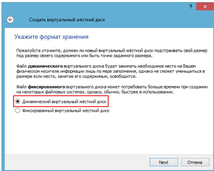
Важно правильно выбрать место хранения виртуального жесткого диска. В идеальном варианте его следует хранить на отдельном от системного жестком диске. Это связано с тем, что при выполнении операций чтения или записи на жесткий диск внутри виртуальной машины в момент высокой нагрузки выполнение этих же операций в основной ОС будет значительно замедляться.
