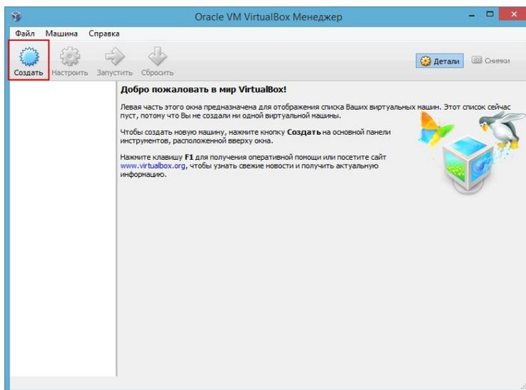
В поле «Имя» введите произвольное имя виртуальной машины (например, Debian). После этого автоматически определится тип операционной системы, но также можно выбрать его вручную, выбрав соответствующие значения полей: «Тип» - Linux, «Версия» - Debian (64 bit) или Debian (32 bit).
