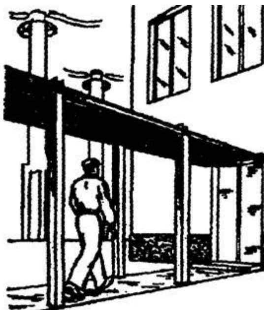
Рисунок 1.4 - Экранирующий навес над проходом в здание
